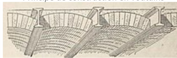
Principe de construction en voûtains
