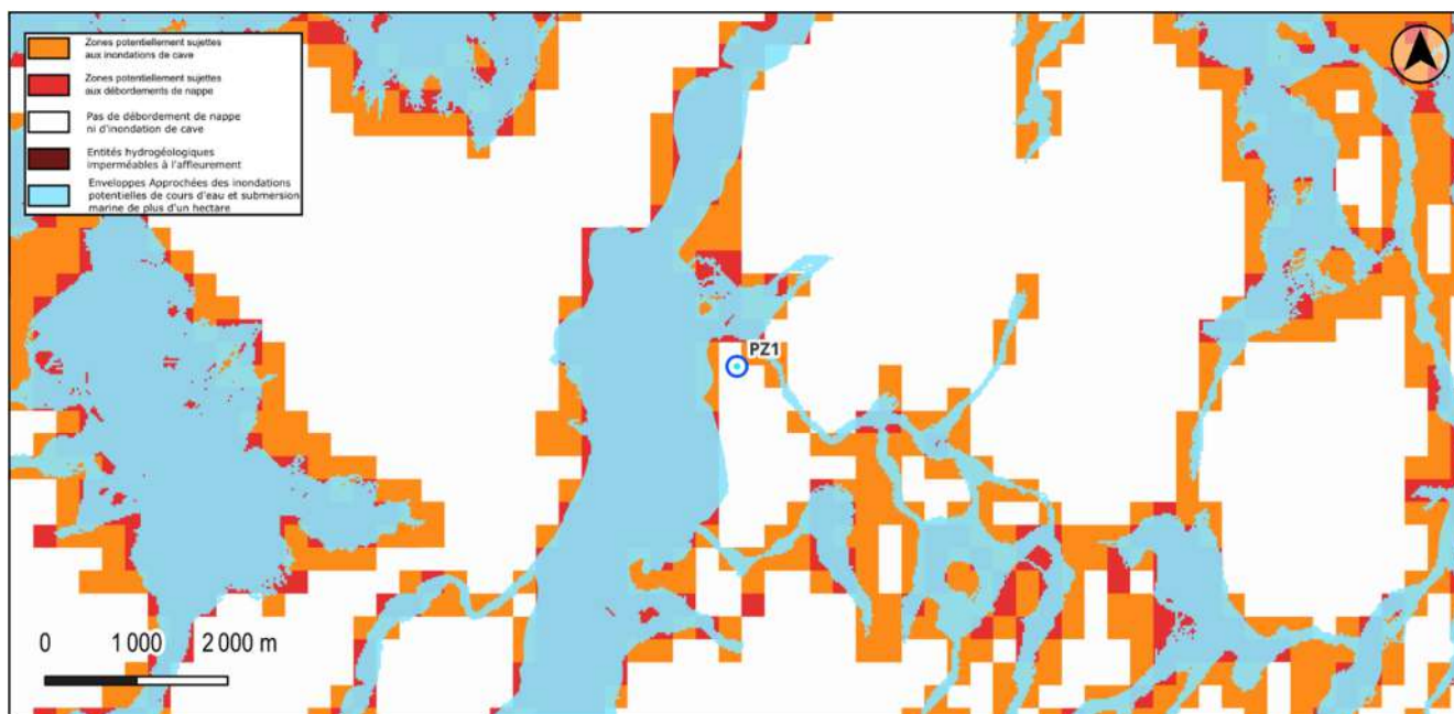
Figure 2 : Carte des remontées de nappe (Source : Géorisques)
